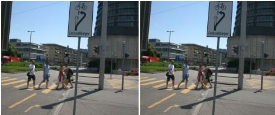
Abb. 20 Indirektes Linksabbiegen in Basel (Ecke Nauenstrasse / Aeschengraben) (Quelle: Rapp Trans AG)
