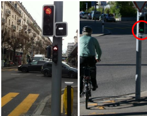
Abb. 28 Links Kreuzung Carl-Vogt / Sainte-Clotilde, Genf (synchron mit MIV-Ampel), Rechts: Zürich Kornhaus- / Nordstrasse (eigene Ampel) (Quelle: Rapp Trans AG)
