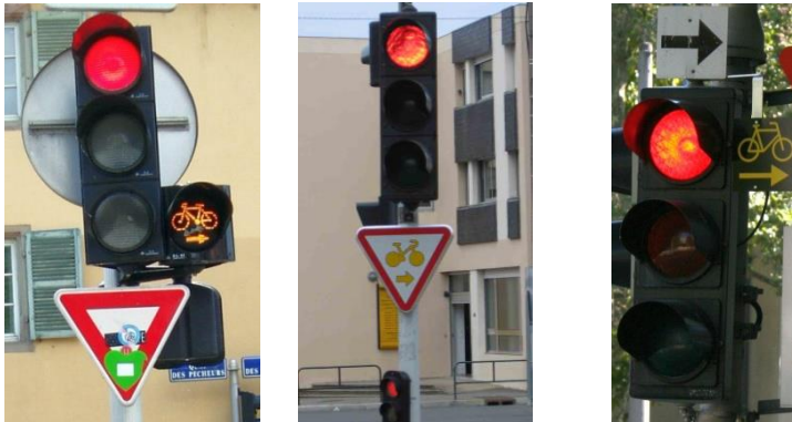
Abb. 17 Strassburg, Ecke Rue de la Pierre Large / Quai des Bateliers (links) in Nantes (Mitte) und in Basel als Pilotversuch (rechts): Rechtsabbiegen bei Rot für Velofahrer erlaubt (Quelle: Rapp Trans AG)
