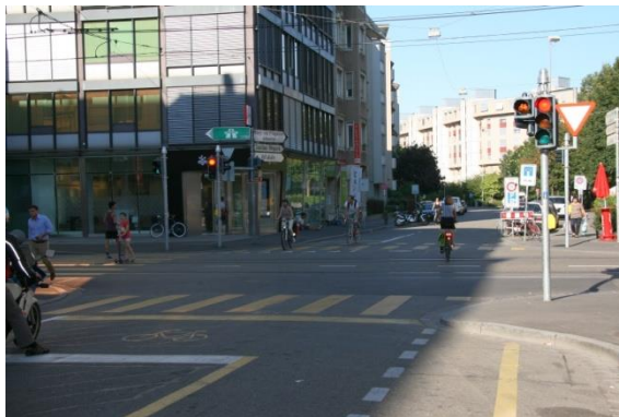
Abb. 27 Während der Langsamverkehrsphase können Velofahrer die Kreuzung in alle Richtungen befahren, Situation beim Pilotstandort in Basel (Quelle: Rapp Trans AG)
